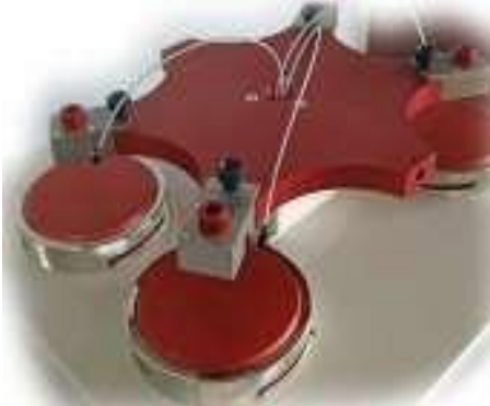
Sistema di bloccaggio rapido del campione
